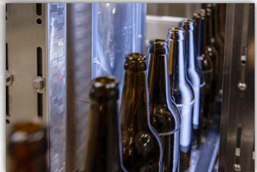
**Innovatives Erkennungssystem.** Hochauflösende Digitalkameras erfassen in Millisekunden jede einzelne Flasche rundum aus verschiedenen Perspektiven. Die sogenannte Deep Learning Technologie vergleicht die Bilder mit millionenfach vorhandenen Bildern in einer Cloud. So erkennt sie tatsächliche Fehler wie feinste Haarrisse, Oberflächenbeschädigungen oder Verschmutzungen und unterscheidet sie von Wassertropfen. Präzise identifiziert sie Abweichungen und sortiert fehlerhafte Flaschen gezielt aus.
